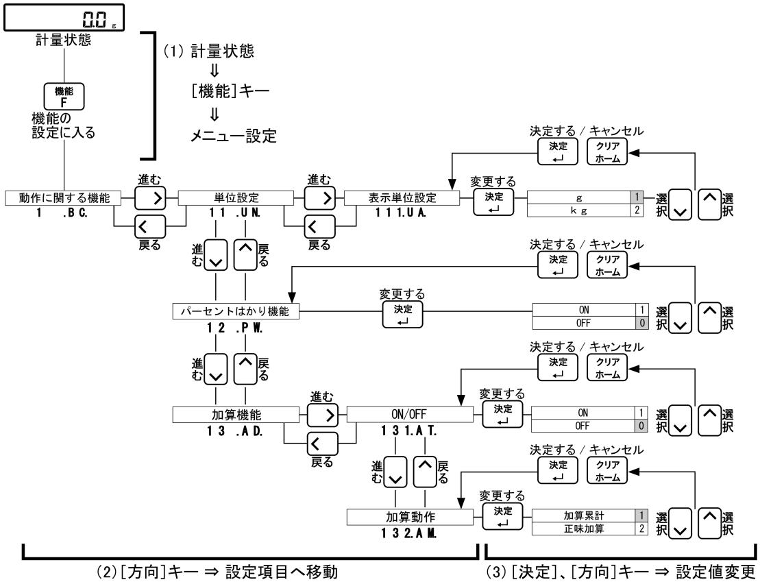
各種機能の設定後に計量状態へ戻るには主に以下の手順を実行します。
