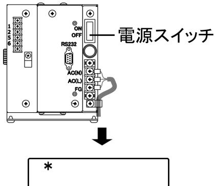
電源ボックスの電源スイッチを ON にします。
