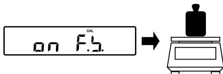
ゼロ点の調整が終了し、表示が「on F. S.」になったら、分銅を計量皿の中心に載せます。
