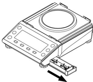
電池ケースの下部にある凹部分に指を掛け、矢印の方向にスライドし、本体から取外します。
