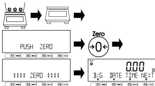
ゼロ点調整範囲を超えた計量物を計量皿の上へ載せた後に降ろします。
