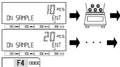
実量設定法（手順 2 で on 5～on 100 または on VAR を選択したとき）において、動作に関する機能で簡易 SCS を有効にした場合、手順 4 の後に簡易 SCS 機能が開始され、計数表示が点滅します。
