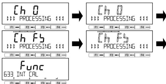
表示が「ch 0」→「ch 0」の点滅表示に変わり、ゼロ点の調整を開始します。
