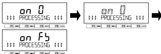
表示が「on 0」→「on 0」の点滅表示に変わり、ゼロ点の調整を開始します。ゼロ点の調整が終了すると「on FS」表示に変わります。
