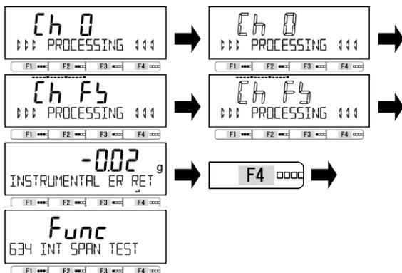
表示が「ch 0」→「ch 0」の点滅表示に変わり、ゼロ点の調整を開始します。
