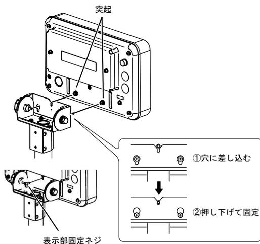
表示部裏面下部にある2つの突起を、角度調整部の穴に差し込み、表示部を下に押し下げます。
