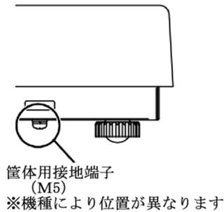
接地端子に付属しているネジ、または同等のネジを使用して接続します。
