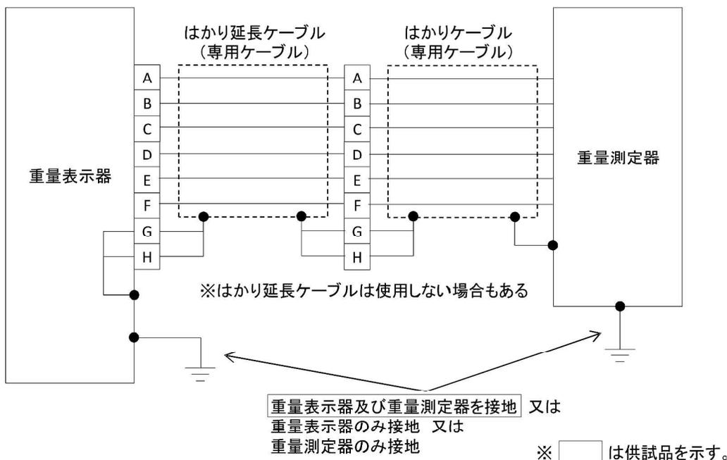
1. 重量表示器、重量測定器は図の様に構成して使用する。
