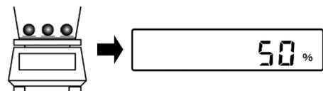
基準重量に対する計量物のパーセントが表示されます。
