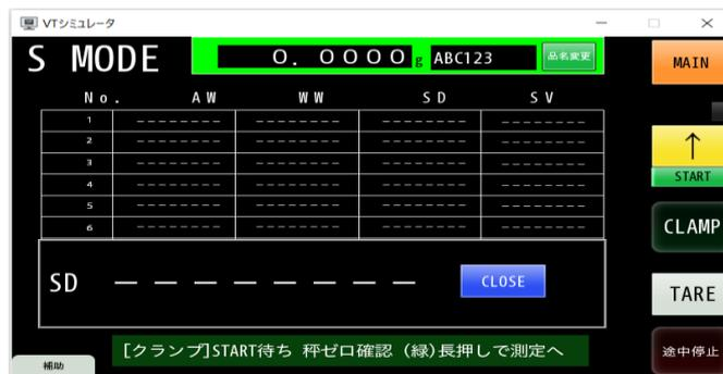
5-3 クランプ補正值 (クランプファクター) を測定する。
