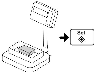
計量物を降ろします。「\*」マークが表示されたら、[Set] キーを押します。
