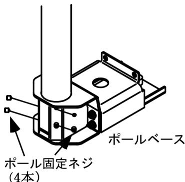
ポール固定ネジでポールをポールベースに固定します。対辺 2.5mm の六角レンチを使用します。
