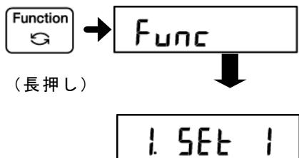
[Function] キーを長押しします。表示が「Func」に変わったらキーを離します。
