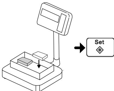
「\*」が表示されたら [Set] キーを押します。数秒間、累計値が表示されてから重量表示に戻り、自動的に風袋引きされます。この操作を繰り返して、累計する計量物をすべて計測します。
