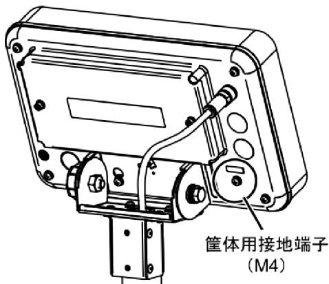
接地端子に付属しているネジ、または同等のネジを使用して接続します。
