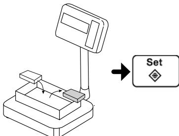
「\*」が表示されたら [Set] キーを押します。計測値が記憶され、数秒間「Σ」と累計値が表示されます。この操作を繰り返して、累計する計量物をすべて計測します。
