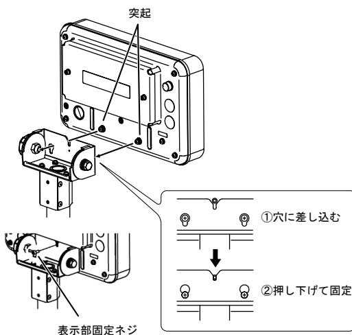
表示部裏面下部にある 2 つの突起を、角度調整部の穴に差し込み、表示部を下に押し下げるます。
