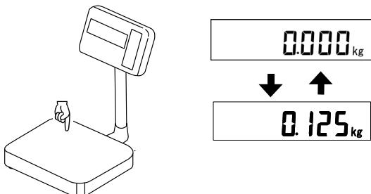
計量部を軽く押し、表示が変化することを確認します。
